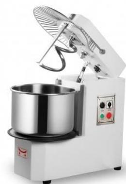
Тестомесильная машина Kocateq HS20 предназначена в пекарнях и на предприятиях общественного питания для замеса дрожжевого теста и других видов с влажностью не менее 45%. Модель оснащена аналоговой панелью управления с кнопками пуска и аварийной остановки. Дежа выполнена из полированной нержавеющей стали, месильный крюк, сепаратор, защитная решетка из нержавеющей стали, корпус из эмалированного стального листа.
