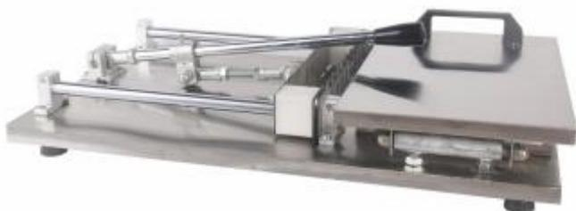
Нанизыватель мяса для одновременного нанизывания шашлыка на 8 шпажек длиной до 400мм.
