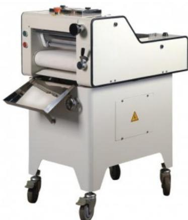
Формователь теста для производства коротких батонов длиной не более 28 см из предварительно округленного дрожжевого или сдобного теста.
