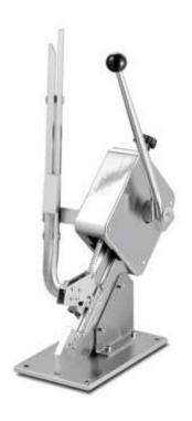
Механический клипсатор одинарный для герметичного пережимания набитых купат и колбас, получаемых с помощью шприцов, клипсами U формы.
