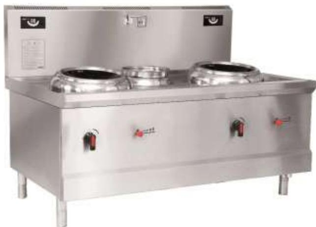
Плита индукционная WOK напольная с 2 сферическими индукционными конфорками диаметром 40 см (по 16 кВт), дренажным стоком и расположенной посередине подогреваемой емкостью.
